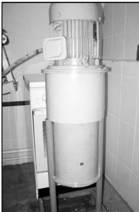
4 Сурет - Механоактиватор диірмені
