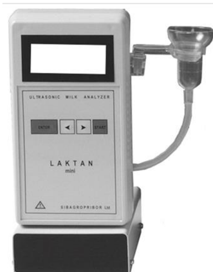
5 Сурет- Сүт анализаторы Лактан 1-4 М мини
